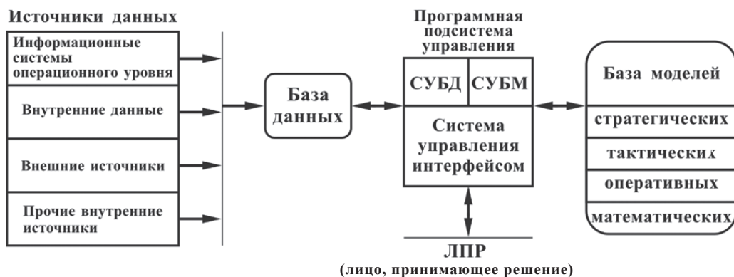
Рис. 1. Общая структура принятия решений с применением СППР, где: СУБД — система управления базами данных; СУБМ — система управления базами моделей
